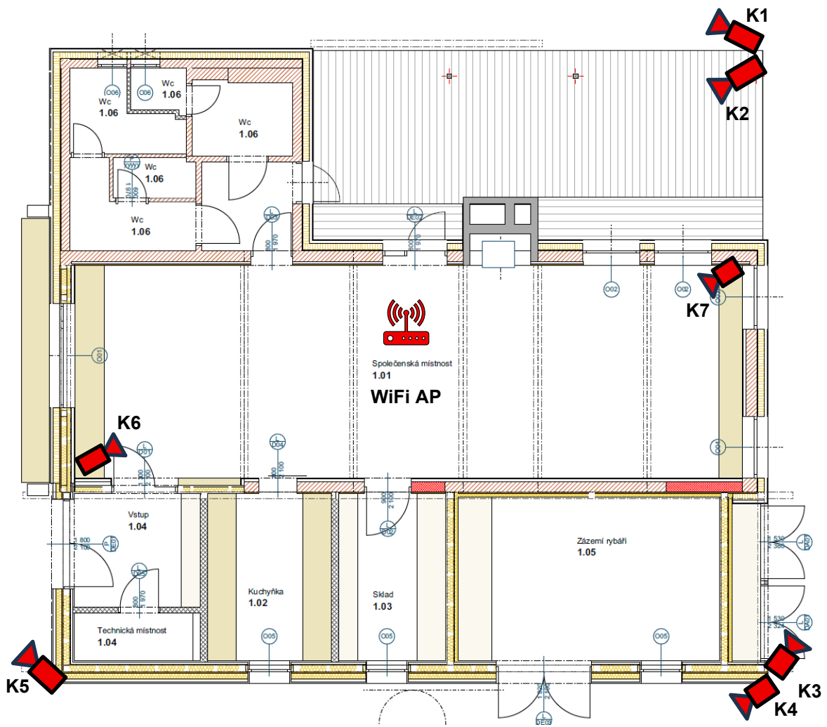
Rozmístění kamer objekt rybárny (RB).
